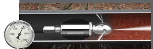
Setzen Sie die Pumpe wieder unter Druck, um in den Reinigungsmodus/Schneidmodus zu wechseln.
